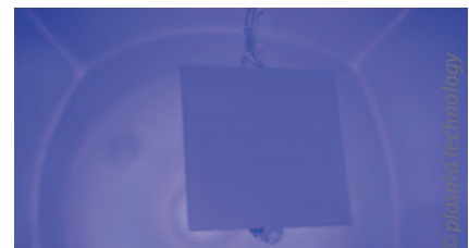
Bild 2: Edelstahlprobe bei der Reinigung im Niederdruckplasma
